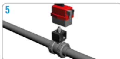
5. Montaje del actuador./Actuator assembly.
