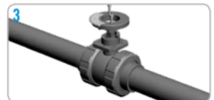
3. Desmontaje de la corona gatillo./ Trigger crown disassembly.
