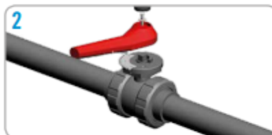
2. Desmontaje de la maneta./Handle disassembly.
