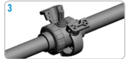
3. Colocación de la abrazadera soporte./ Installation of support clamp.
