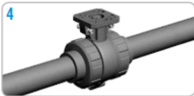
4. Apriete de los tornillos de la abrazadera soporte./Tighten of the support clamp bolts.
