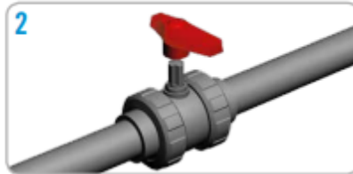
2. Desmontaje de la maneta./ Handle disassembly.
