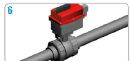
6. Válvula de bola motorizada lista para su funcionamiento./Motorized ball valve ready for working.
